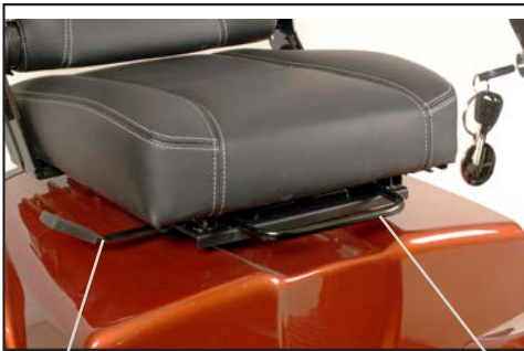
Utløserhåndtak for setedreining. Utløserhåndtak for sete frem/tilbake.
