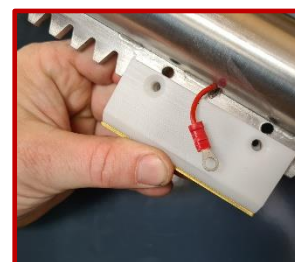
Figur 16: Tilkobling av positiv kabel på ladepunktet
