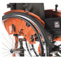
Skyv for å låse, integrert i klesbeskytter, Safari
