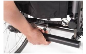
AGN090008 Tippesikring flip up opereres av bruker
