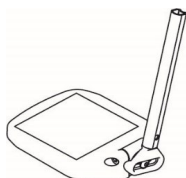
Fotplate vinkel- og dybdejusterbar
