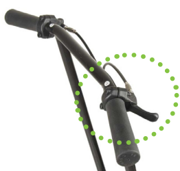
Ledsagerstyrt Buster Man. med betjening plassert på kjørebøylen.
