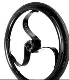
Loopwheels, Drivhjul med fjæring
