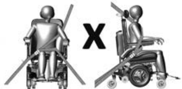
Figur 5.6 - Feil plassering av trepunkts setebelte
