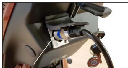
Ladestik forbindes til 3-polet stik på styrstammen. Ladesticket er placeret under beskyttelsespladen.
