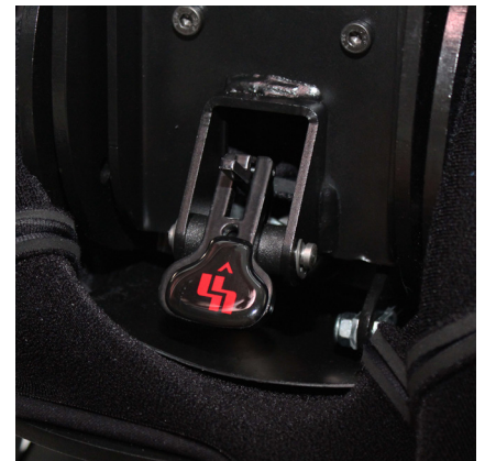
Utløserpakken i sikret posisjon
