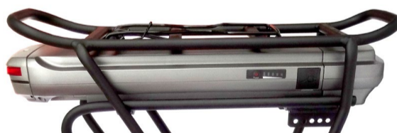
Batteri i batterihus på bagasjebrett 22900
