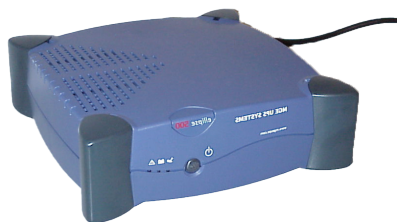
Batteri Back Up (stol fungerer ved strømbrydd)
