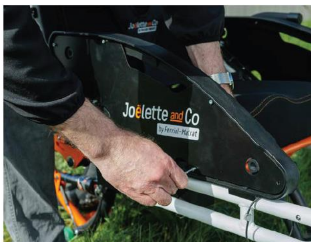
3. Skru inn skruene fra utsiden foran hver mutter.
