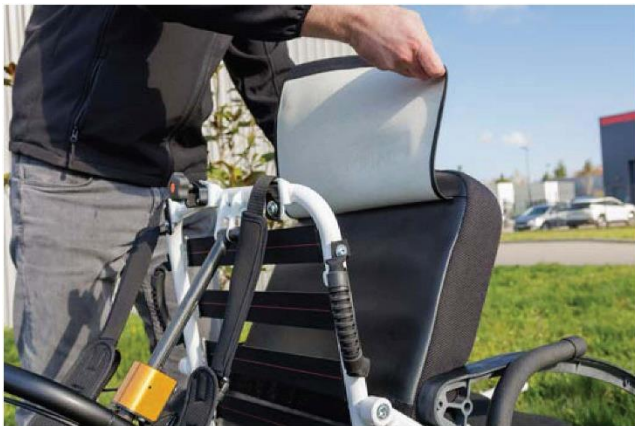
11. Før ryggstøtteklaffen bak de elastiske stroppene og fest den med borrelåsremmen.
