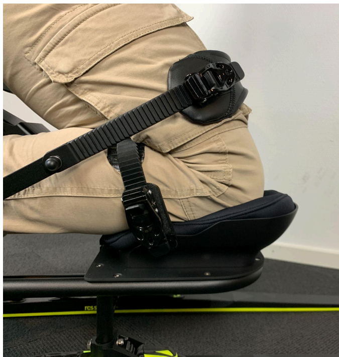
Figur 3.2.2b - Lårbelte kombinert med belte bak kne
