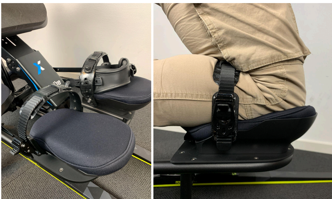
Figur 3.2.2c - Belte bak kne uten bruk av lårbelte
