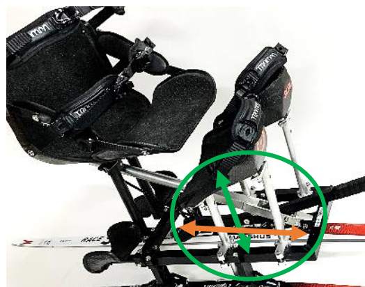
Figur 11 Hevede knekopper på kjelke. Høydejusterbare , og fortsatt justerbare i horisontal plassering .
