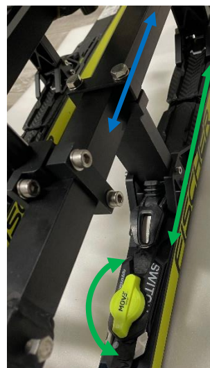
Figur 10 En kan påvirke trykkfordelingen på skien ved å flytte på bindingsfestene eller justere bindingen .
