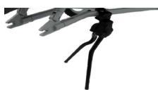
Støttefot til påsettelse av sykkelvognfeste og bytte av hjul
