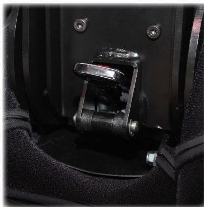
Utløserpak for regulering av hoftevinkel
