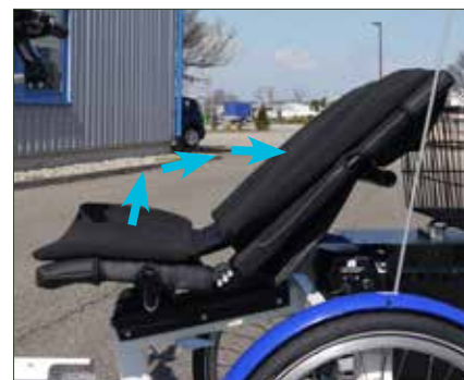
Ryggstøtten – på det behagelige setet kan stilles inn for å passe til alle behov.
