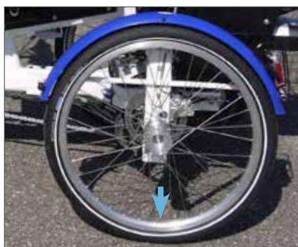
Forsterkede felger – tåler både høy belastning sideveis og langtidsbelastning.
