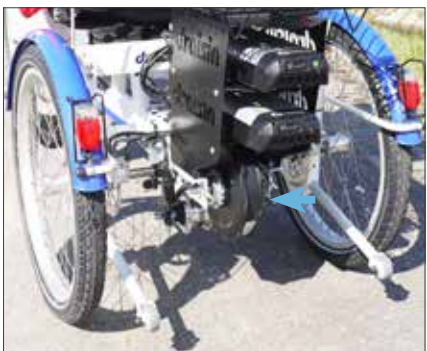
El-motoren – befinner seg bak og driver begge bakhjulene symmetrisk via differensialen.
