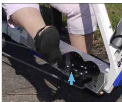
Fotplatene på høyre og venstre side – De forhindrer at føttene sklir bakover og gir en sikker pedalbevegelse.
