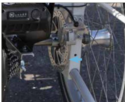
Hydrauliske bremsere – på alle tre hjul.
