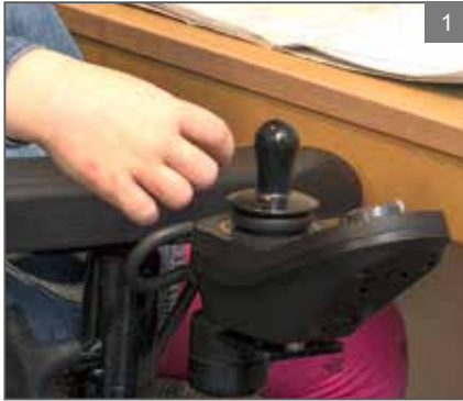
// ENKEL BETJENING: Bortsvingbar styreboks med enkel betjening av kjøre- og setefunksjoner. Tilrettelagt for blåttann.
