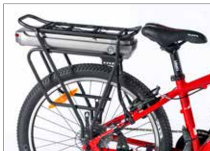
Batteriet er montert under bagasjebrettet.
