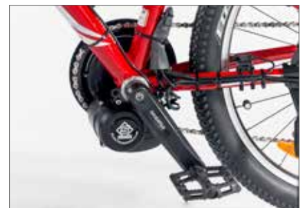
Den smidige krankmotoren kan monteres på de fleste sykler.
