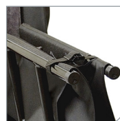
Låse sammenslått ramme Festes rundt et av seterørene. Når rammen er sammenslått dras remmen rundt begge rørene og låses med en spenne.
