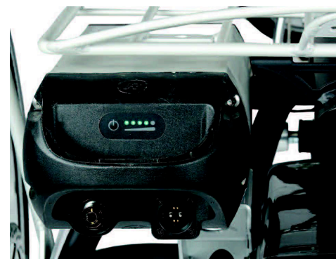
Litium Ion-batterier Tilgjengelig i både 36 V 11 Ah og 36V 25 Ah.
