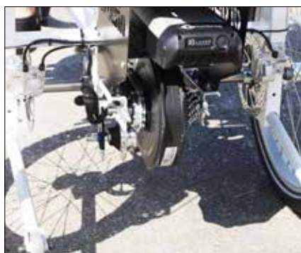
500 W motor i bakhjul, spinner ikke i motbakke
