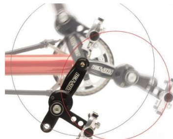
Pendelpedal For de med begrenset mobilitet i en fot, f.eks stivhet.
