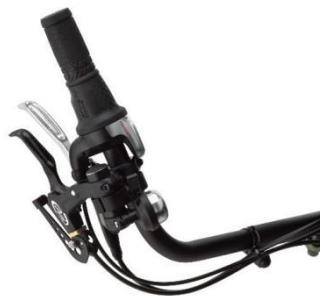
Enhåndsfunksjon bremses Hvis du er svak i den ene handen kan alt flyttes over til den andre siden
