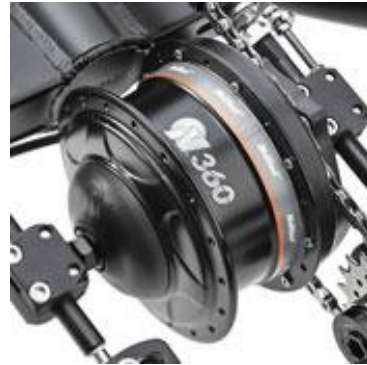
Nuvinci automatgir. Trinnløst planetarisk
