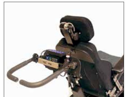
Ledsagerstyring med guide (alt2) For kun ledsagerstyring. EF-150-S Ledsagerstyring Medema guide inkl feste og nødstop EF-150-1 Ledsagerstyring styringsenhet inkl styreboks Master, betjeningspanel, aktuator og kabelsett
