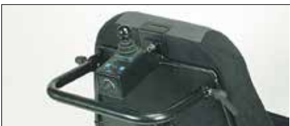
Ledsagerstyring joystickstyrt Med justerbar bøyle/håndtak. CR-00774KPL Kpl sett inkl joystick
