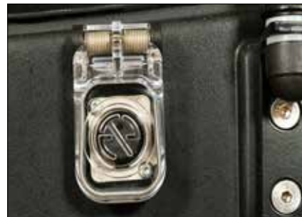
Utvendig ladestikk kabin M-127-06-966
