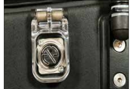
Utvendig ladestikk kabin M-127-06-966
