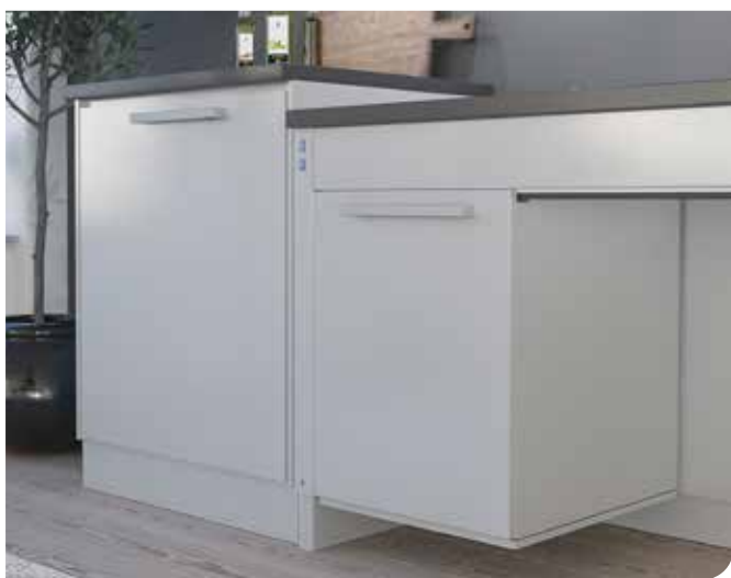
Klemsikring i form av klemsikringsplater under skap og klemsikringslist under de knefrie delene stopper heisen dersom noe kommer i kontakt med bryterne.
