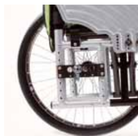
Bakhjulsadapter med 48 olika positioner
