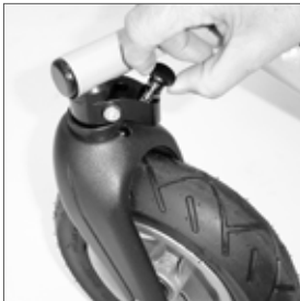
Forhjul med retningslås, er standard
