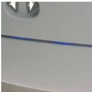
Blått lys indikerer at motoren er i bruk. Lyset blinker ved lavt batterinivå.
