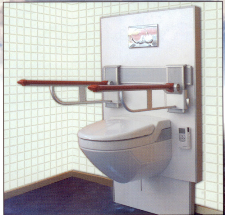
Under: Manuell høydejusterbart veggtoalett med innebygd systerne. Sitte høyde 42-57 cm. Består av følgende: Art.nr. VU-8000 (veggtoalett) Art.nr. R-8141 (Pressalifcare heis med sveiv) Kan leveres med toalettstøtter.
