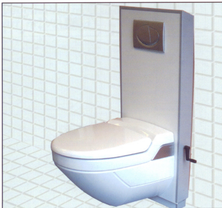
Over: Veggtoalett med elektrisk heis og innebygd systerne. Sitte høyde; 42-82 cm. Består av følgende: Art.nr. VU-8000 (veggtoalett), Art.nr. R-3546 (høydejusterbare støtter) Art.nr. R-8240 (Pressalifcare elektrisk heis)
