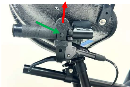
Figur 9 Bremsehendel og parkbrems til hjulsettet
