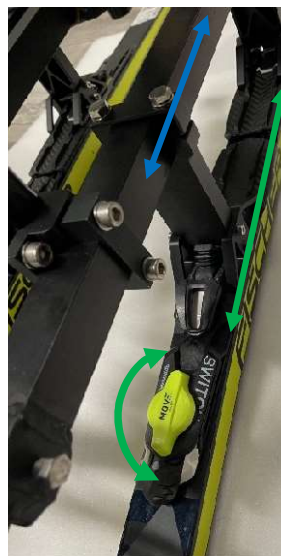
Figur 7 En kan påvirke trykkfordelingen på skien ved å flytte på bindingsfestene eller justere bindingen .
