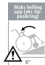
Stolen kan velte dersom bakoverhellingen er større enn 6°. Bruk tippesikring!
