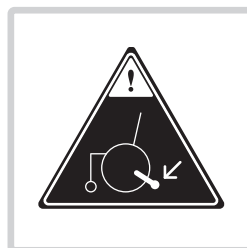
Tippfare: Ha alltid tippesikringen nedfelt når du kjører.
