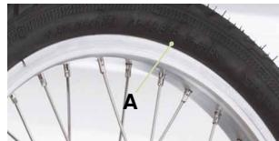
Hvis løpeflatene etter bare litt når du trykker hardt på dekket med tommelen, er dekktrykket korrekt. Bruk et manometer for nøyaktige verdier!
