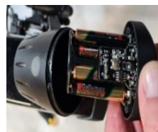
Skyve fronten ut av huset
