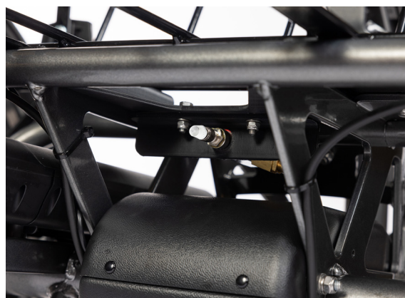
Figur 6: Justering av lufttrykket kan gjøres under bagasjekurven.
