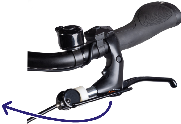
Figur 1: Du kan (de-)aktivere parkeringsbremsen ved å bevege denne spaken.
