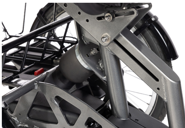
Figur 5: Luftfjæringen er plassert mellom bagasjekurven og setet.
