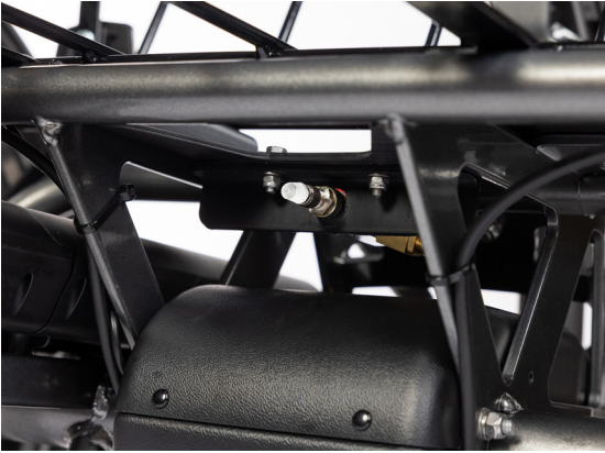
Figur 7: Sykkelventilen er plassert under bagasjekurven.
