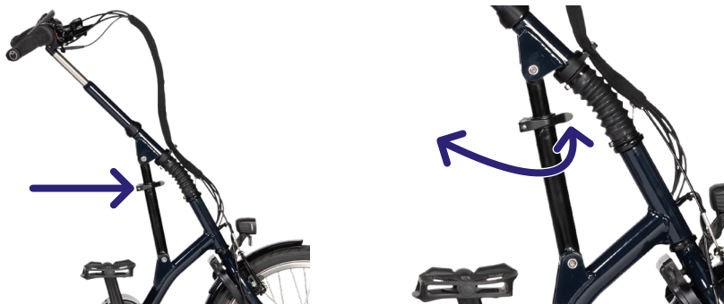
Figur 3: Denne illustrasjonen viser hvordan styret kan justeres.
