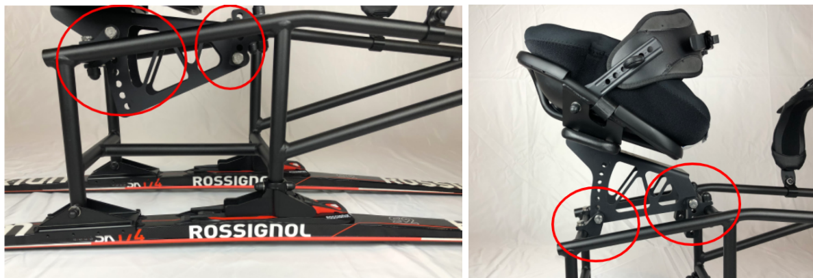
Figur 6.4 - Klemfare ved setearm markert med røde sirkler. Obs: Skiene på bildet avviker fra leveranse.
