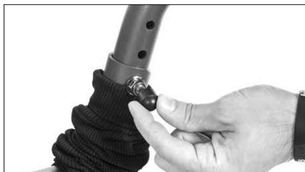
10. Sett den svarte beskyttelseheten på mutteren.
