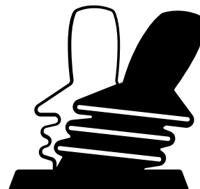
Bilde 59. Styrespaken flyttes fra nøytral posisjon.
