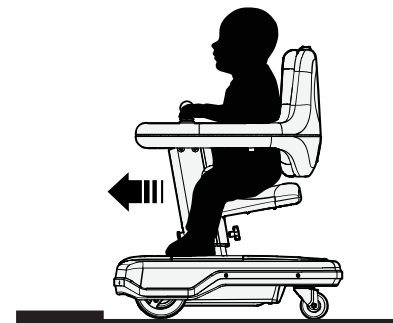
Bilde 54. Kjøre over hindringer.
