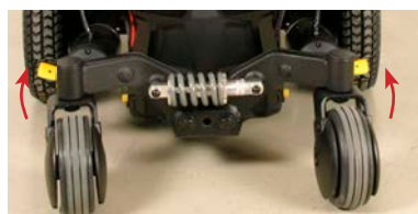
Normal posisjon for kjøring - skjøvet opp
