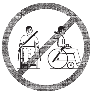
Feil bruk av belte
