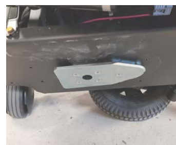
Docking låseplate montert.
