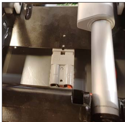
Forbind kontaktene igjen, med å styre/trykke med det røde håndtaket.
