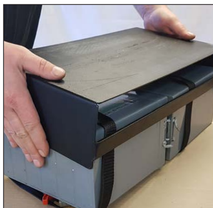
Legg over batteriskuffen, og vend alt helt rundt.
