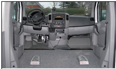
Docking station monteret på i førersiden og i passagersiden.
