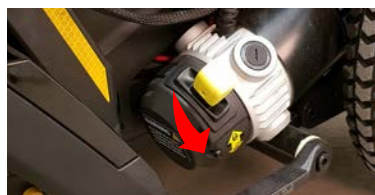
Posisjon for frikobling - skjøvet ned
