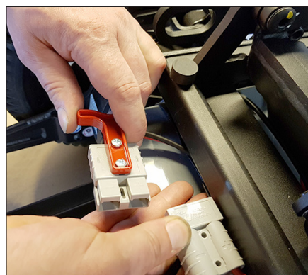
Frigjør kontakten med å dra i det røde håndtaket.
