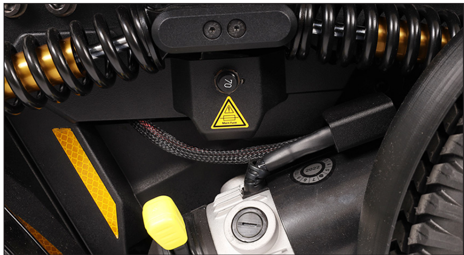
Her finner du automatsikringen.
