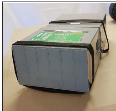
Legg batteriene med polene mot hverandre.
