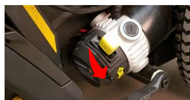
Posisjon for frikobling - skjøvet ned
