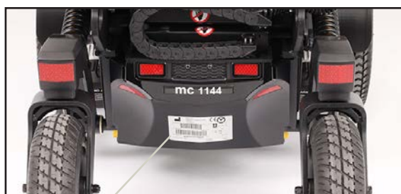
Serienummerskiltets plassering på kjøretøyet.
