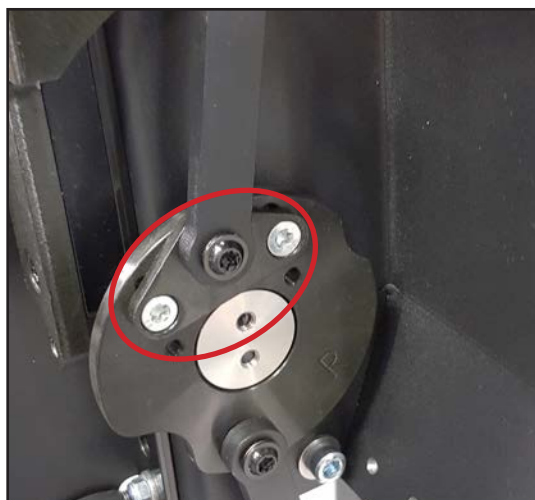
I de ytre hullene (hull 1) lavere sete 80 mm
