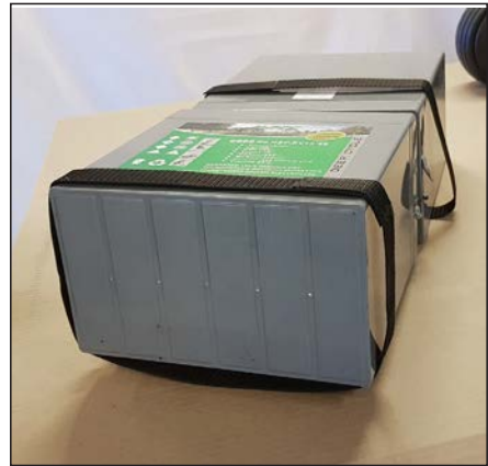
Legg batteriene med polene mot hverandre.
