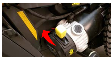
Normal posisjon for kjøring - skjøvet opp
