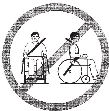
Feil bruk av belte
