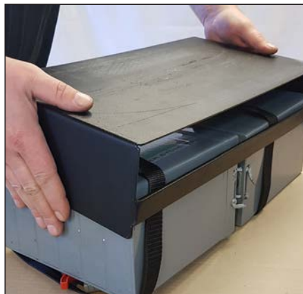
Legg over batteriskuffen, og vend alt helt rundt.
