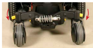
Posisjon for frikobling - skjøvet ned
