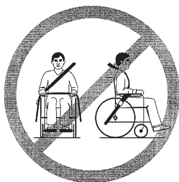
Feil bruk av belte
