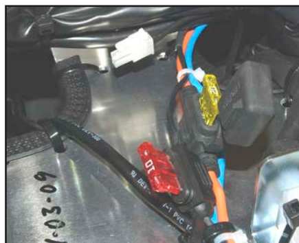
Fjern bakskjermen. Klem på sidene av plastlokket og ta det av. Skift sikringen.
