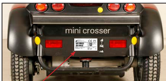
Serienummerskiltets plassering på kjøretøyet.
