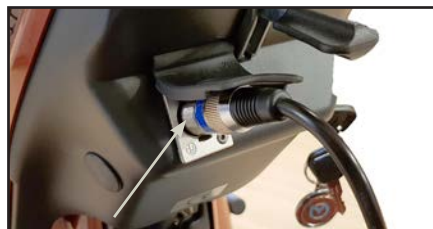
Ladestik forbindes til 3-polet stik på styrstammen. Ladestikket er placeret under beskyttelsespladen.
