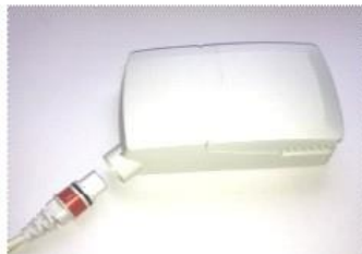
5. Strømkabelen løsnes fra elektronikkboksen gjennom å trykka inn de røde hurtigfestene og dra ut kontakten.
