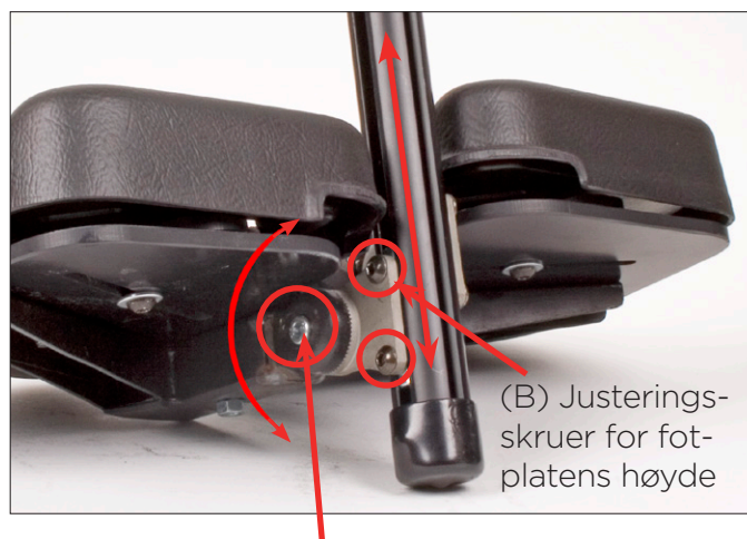
(C) Justeringsskruer for fotstøttevinkel
