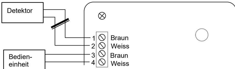
**HINWEIS:** Wenn externer Detektor und Bedieneinheit an der selben Klemme angeschlossen und eingestellt sind, entsteht beim Aktivieren von Bedieneinheit und Relais ggf. ein Kurzschluss am Detektor/Detektorkabel (Türöffnung!).
