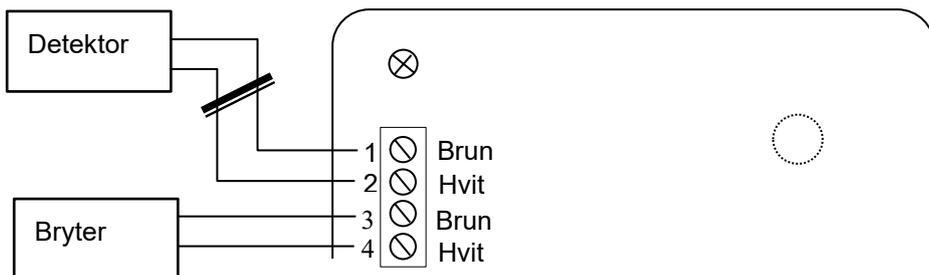
**MERK:** Hvis ekstern detektor og albuebryter monteres på samme punkt, vil detektoren aktivere albuebryter, og releet aktiveres (dør åpnes!).
