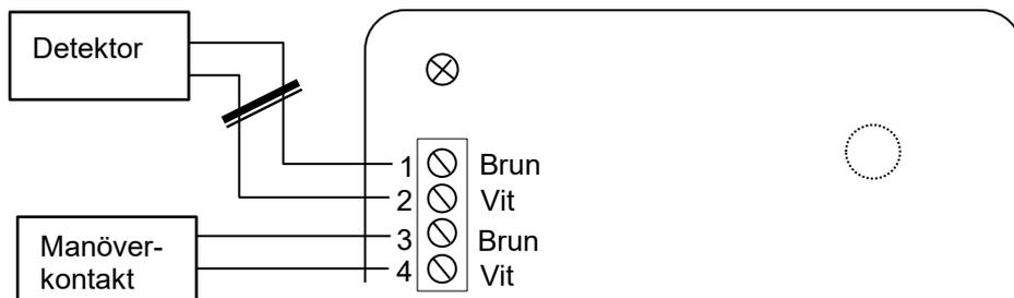
**OBS:** Om extern detektor och manöverkontakt ansluts och programmeras på samma plint kommer eventuell kortslutning av detektor/detektorkabel att registreras som tryck på manöverkontakten och reläet aktiveras (dörröppning!).
