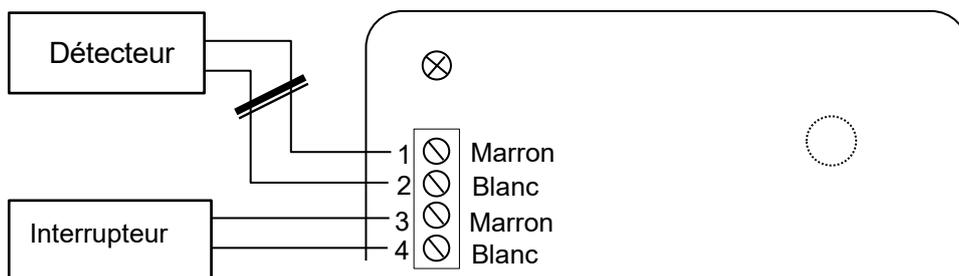
**REMARQUE :** Si le détecteur externe et l'interrupteur de commande sont raccordés et programmés sur la même borne, tout court-circuit du câble/détecteur externe sera enregistré comme une activation de l'interrupteur de commande et le relais sera alors activé (la porte s'ouvrira!).
