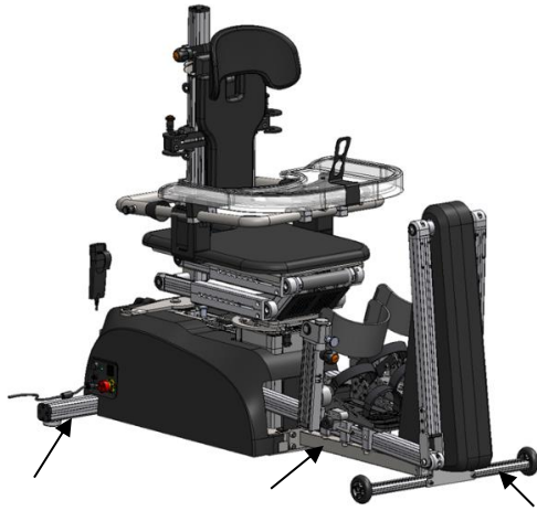
Bilde 21 – Hvis Innowalk skal løftes, løft alltid i rammene.
