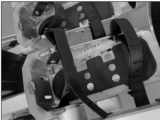
Bilde 36 – Såler for å utjevne benlengdeforskjeller
